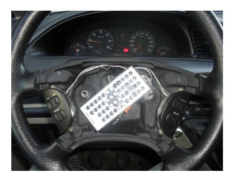
Ahora solo nos queda buscar el conector de los mandos del volante que se conecta a la radio original del coche. En ese conector conectaremos dos cables en las patillas que se correspondan con los que hemos soldado anteriormente en el conector negro del volante. Para saber su correspondencia podemos usar un polímetro en continuidad.
