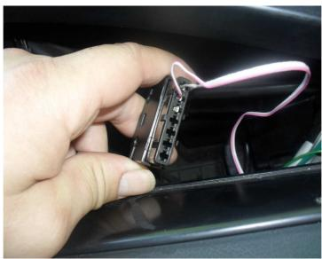
Una vez tengamos los cables montados los pasamos entre el salpicadero y la radio, soldamos el led con su respectiva polaridad y lo ubicamos, probamos que todo funcione, montamos el airbag y listo.
