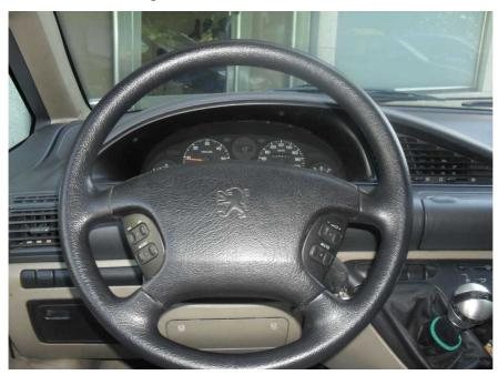
Para este trabajo necesitaremos desmontar los pulsadores y para ello primero tendremos que desmontar el airbag.
