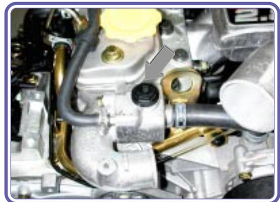
6. Con el motor apagado, llenar el sistema a través del depósito, hasta que el líquido salga por el tapón de purga (figura superior).
