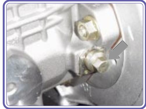
3. Instalar nuevamente la polea, ubicándola de forma tal que la marca de sincronización quede hacia adelante. Apretar el tornillo según el torque recomendado.
