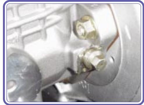
10. Sacar de la polea de mando, los tornillos de fijación de la maza de la bomba y la placa.
