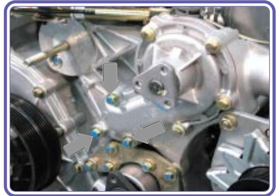
8. Sacar los 8 tornillos de fijación de la bomba de agua, anotando la posición de los 3 tornillos pasantes en el block de cilindros (indicados en la figura).
