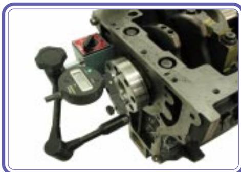
10. Verificar el juego axial del cigüeñal utilizando un reloj comparador. Si se verifican valores superiores a lo especificado, reemplazar las arandelas de empuje por otras de sobremedida.
