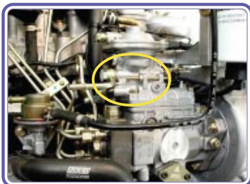
**El régimen de revoluciones en ralenti es el único ajuste permitido en servicio. Cualquier ajuste adicional deberá ser efectuado por un representante autorizado Bosch.**
