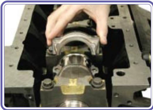
8. Después de montar la quinta bancada, aplicar Loctite 5900 en las canaletas laterales del cigüeñal.
