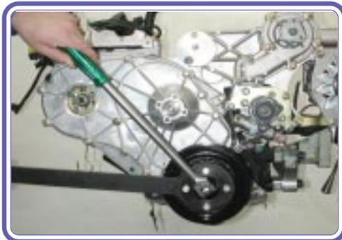
6. Aflojar los tornillos de fijación del volante del motor y retirarlos.
