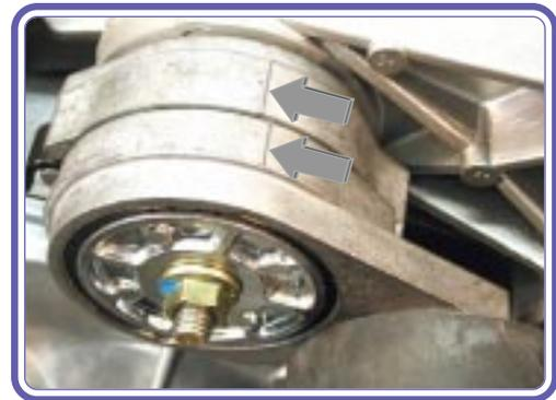
1. Colocar una llave estriada en el tornillo de fijación del tensor de la correa de mando de las bombas y el alternador.
