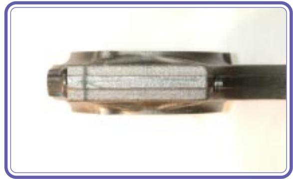
5. Verificar la deformación y el alineado de la biela.
