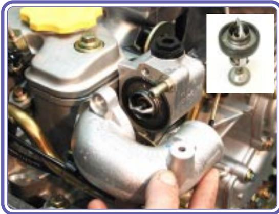
El test inicial indicado en este manual para probar el termostato, ayuda en el diagnóstico de posibles fallas en el motor. En caso de que el test indique comportamiento fuera de lo especificado, se recomienda someter al termostato a un ensayo mas riguroso (en laboratorio). Se deben verificar las causas del sobrecalentamiento, ya que en la mayoría de los casos no es la válvula termostática la responsable principal del problema.
