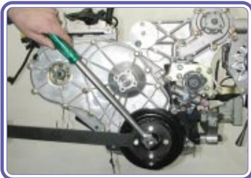
6. Retirar el tornillo de fijación de la polea del cigüeñal, utilizando una manija de fuerza del largo adecuado.
