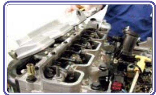
16. Sacar los vástagos de los botadores del árbol de levas, capas y trabas de válvulas, identificándolos para su posterior reinstalación en la misma posición.
