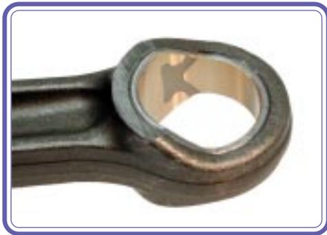
2. Montar el pistón en la biela con la cámara de combustión hacia el mismo lado que la traba del casquillo. Introducir manualmente el perno y montar los anillos de traba nuevos. Si hubiera alguna dificultad para montar el perno, calentar el pistón en agua o aceite a 80°C. El pistón debe ser manipulado con cuidado, ya que cualquier daño en su superficie puede ocasionar un mal funcionamiento del motor. Si la biela y el pistón no fueran reemplazados, montarlos en el cilindro correspondiente.
