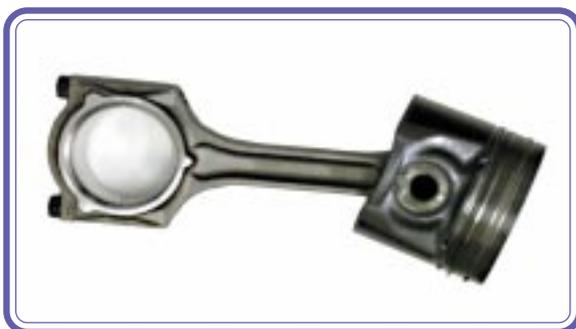
3. Montar el resorte en la 3ª ranura del pistón y a continuación el aro, con los extremos en posición opuesta a los extremos del resorte. Instalar los aros 2º y 1º con la marca TOP o el chaflán interior hacia arriba. Observar que los aros de la 2ª y 1ª ranura sean de espesores diferentes.
