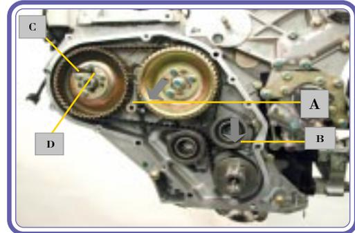
3. Aflojar los 3 (tres) tornillos de fijación de la polea de la bomba inyectora (Ref. D), dejando la polea ligeramente floja para permitir que la correa se acomode.
