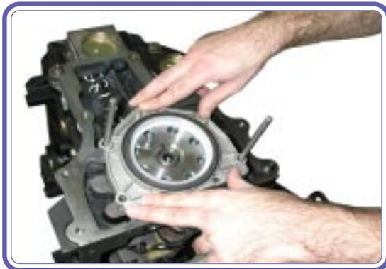
Verificar que el labio del retén asiente uniformemente en la brida del cigüeñal, evitando que se doble.
