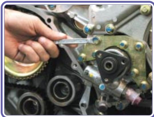
10. En caso de instalar una bomba nueva, retirar el soporte de montaje y los conectores de mangueras de la bomba existente e instalarlos en la bomba nueva.
