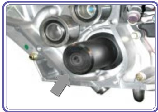
4. Instalar la polea dentada del cigüeñal, hasta hacer tope, controlando que el "O" ring de sello quede correctamente asentado. Utilizar la herramienta nº 8130637.
