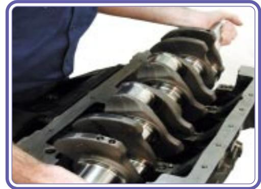
5. Colocar el cigüeñal en posición vertical, encajado en el volante del motor, evitando el riesgo de deformaciones.
