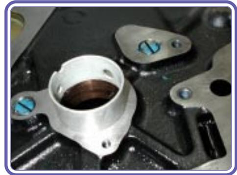
4. Montar el retén trasero del árbol de levas, aplicando Loctite 609.
