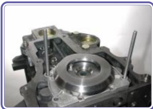
5. Instalar la herramienta nº 8130648 y hacer girar los dos vástagos en sentido horario, para fijarlos en los agujeros ubicados en la brida del cigüeñal.
