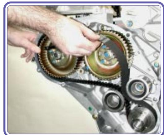
Las correas se deben almacenar apoyando los bordes sobre una superficie limpia y de modo que los pliegues no presenten un radio inferior a 50mm. No se deben plegar las correas en ángulo agudo o con un radio inferior a 50mm, ya que pueden provocarse fallas prematuras.
