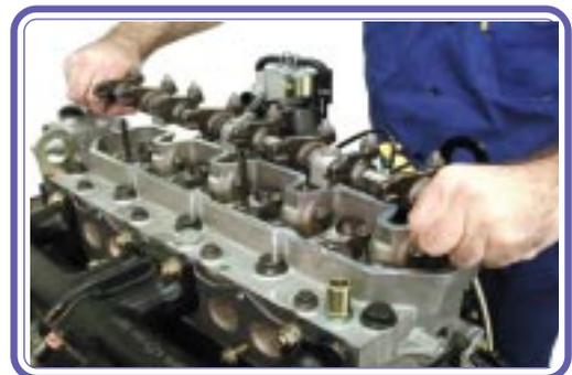
3. Sacar las varillas del árbol de levas, identificándolas para su posterior reinstalación en la misma posición.
