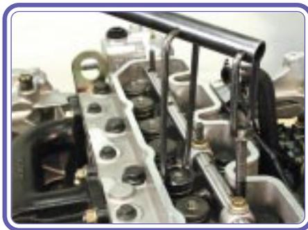
3. Sacar las trabas, el platillo de los resortes, los resortes, la arandela y el retén. No hacer girar el cigüeñal antes de terminar la operación de reemplazo, para que la válvula no caiga dentro del cilindro.
