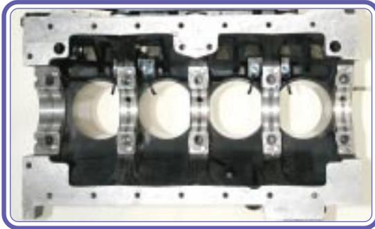
En caso de que se dificulte el giro, verificar todos los torques aplicados en la fijación de las bielas.
