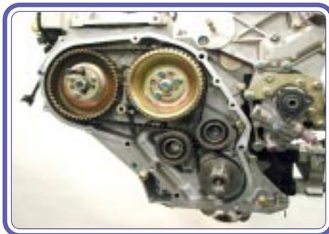
6. Introducir el perno de la herramienta nº 8130633 en la polea de la bomba inyectora y encajarla en la brida de la bomba.
