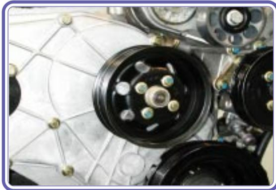
3. Sacar la correa de mando del ventilador. Ver **CORREAS DE MANDO DE LOS ACCESORIOS** - Desmontaje.
