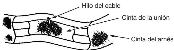
Unión cubierta
