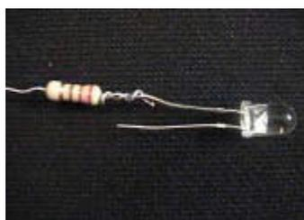
Resistencia conectada al positivo del LED
