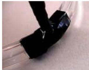
Cinta aisladora asegurando y protegiendo los LEDs
