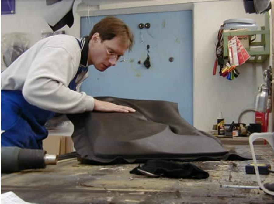
**Sujetar todo bien y asegurar que no se va a despegar. Podemos empezar la fase final y enmoquetarla, como se ve bien en la foto. Sujetamos un lado del vinilo con grapas. Vamos pegando con cola de dos caras y luego dando calor con una pistola térmica. Damos la forma necesaria para que quede bien acoplada a todas las formas de la puerta, incluso nos podemos ayudar con un trozo de corcho para los rincones difíciles.**
