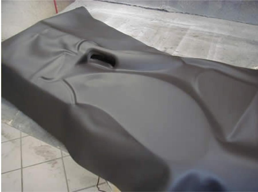
**Con vinilo (nuevo) lo extendemos bien por toda la pieza a recubrir. Lo sujetamos a un lado del panel para poder estirar de él cuando sea preciso tensarlo. Con cola de contacto o con pegamento en spray vamos pegando poco a poco. Con la ayuda de una pistola de calor le vamos dando forma y acoplado a todos los rincones de la pieza.**
