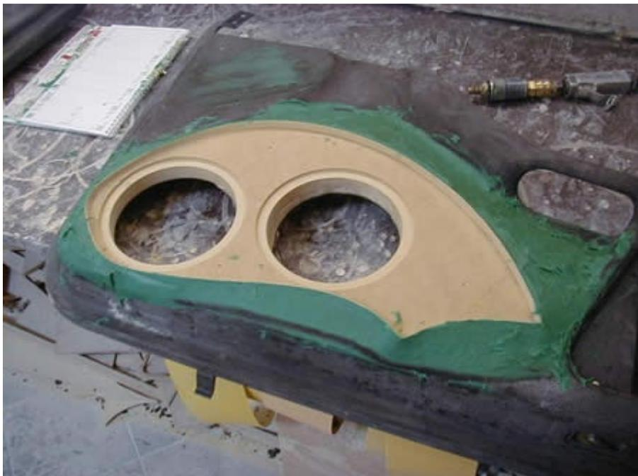
**Lo presentamos y después de atornillarlo al panel original del coche lo pegamos con la misma resina. En las uniones y bordes lo enmasillamos con poliéster (mezcla de hilos de fibra y resina)**
