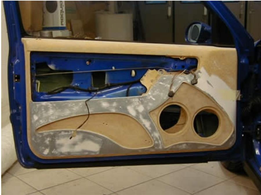
**Una vez la pieza esté bien seca, la lijamos y enmasillamos si hiciera falta, como en la foto, hasta que veamos que no tiene arrugas ni bultos y queda bien acoplada a todas las formas de la puerta original.**
