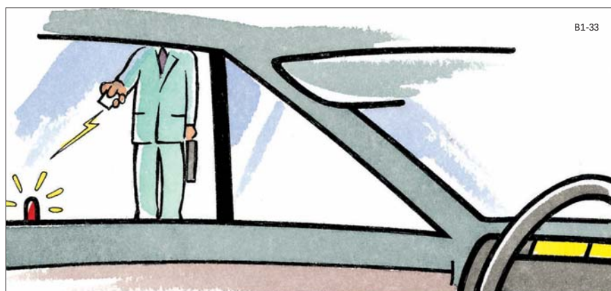
Los rayos infrarrojos se utilizan para transmitir un código invisible a un receptor y que éste pueda accionar un dispositivo.
