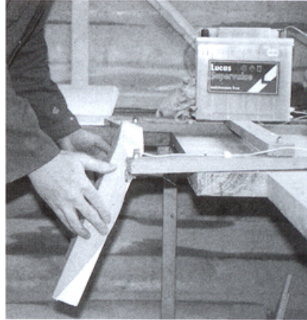
Cortando el poliestireno con alambre caliente.
