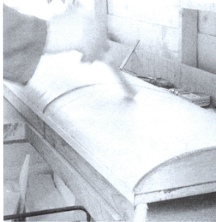
Cubriendo el núcleo de poliestireno con fibra de vidrio y resina epoxy.
