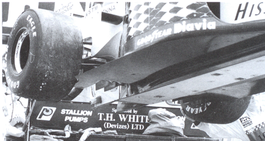
Los canalizadores laterales del difusor pueden verse en la parte trasera del Jordan 197, mientras que la foto inferior los muestra desde abajo.
