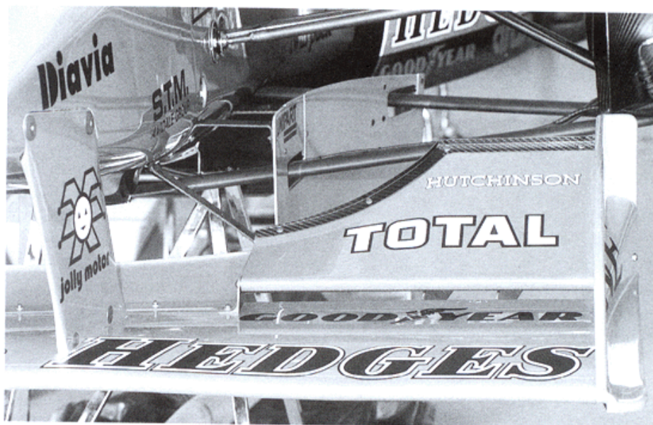
El alerón delantero asimétrico del Jordan 196, una pieza colgante de dos elementos. (Tracey Inglis)
