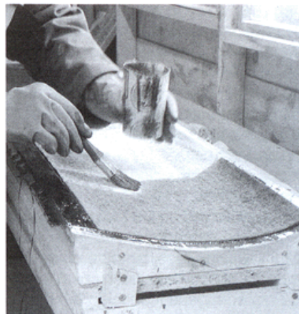
Aplicando resina negra al material de Coremat.
