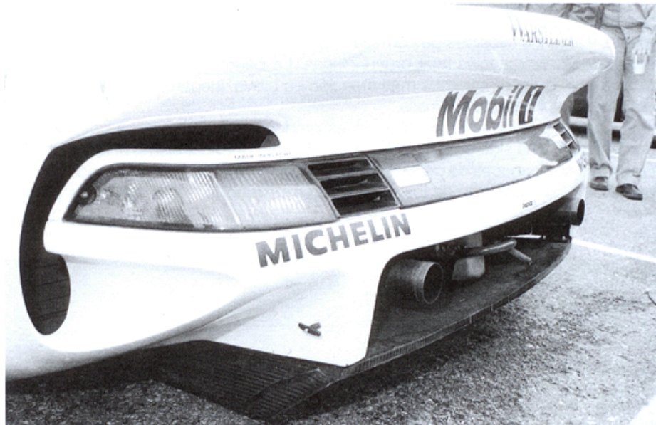
Las derivas laterales impiden que se cuele aire no deseado en el difusor, como en este Porsche 911 GTR.
