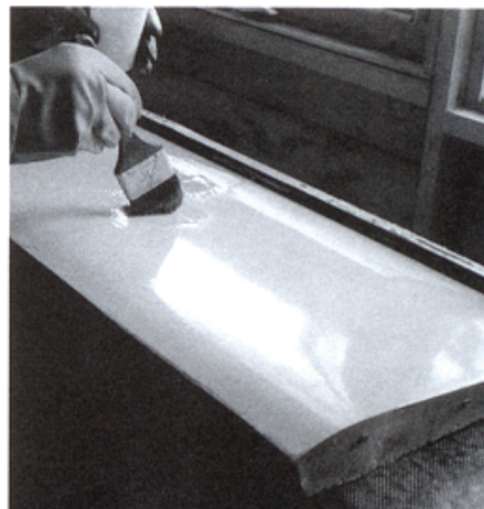
Aplicando una capa de gel transparente sobre el molde. Observe el gel de color negro en el borde de ataque para ocultar la unión.
