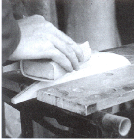
Lijando un formador de perfil para la mitad inferior de la matriz de un ala.
