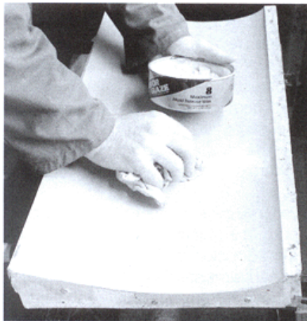
Encerando la parte inferior del molde de un alerón delantero.
