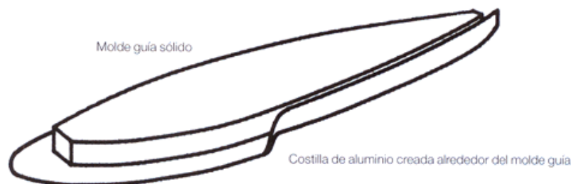
Figura 7.4. Creando una costilla alrededor de un molde guía.
