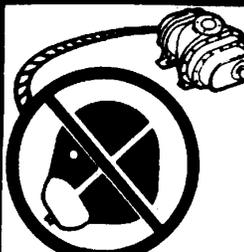
La inhalación de aire comprimido sin equipos de seguridad adecuados puede originar riesgos mortales o muy graves. Consultar las normas vigentes sobre los equipos de seguridad.
