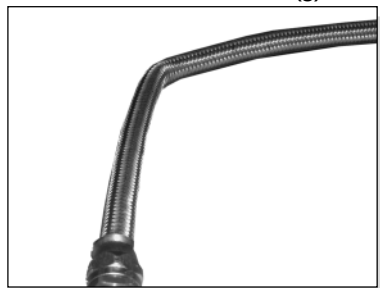
Se muestra una tubería de descarga doblada.
