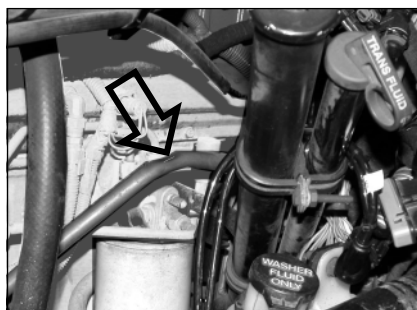
Muestra de una tubería de descarga dañada.
