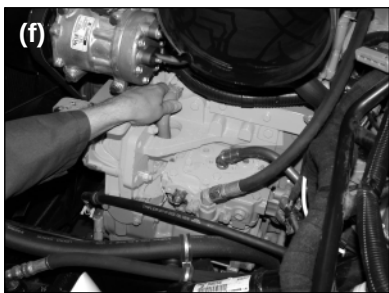
Inspeccionando las mangueras del refrigerante.
