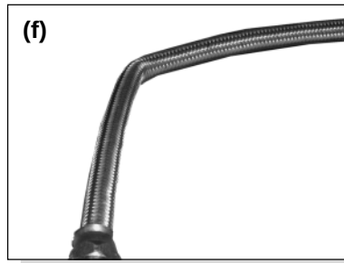
Muestra de una tubería de descarga doblada.
