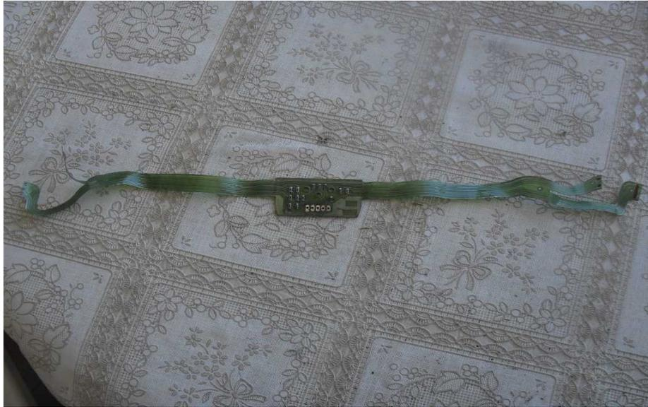
En la foto anterior se muestra lo que queda de la cinta de cable, en los extremos llevaba unos conectores de color verde que he utilizado para soldar los extremos de los cables de los pulsadores del mando a distancia, y soldado a la placa del centro hay un conector negro que tendremos que desoldar, donde se soldarán el par de cables que salen de donde iba montado el led infrarrojo.
