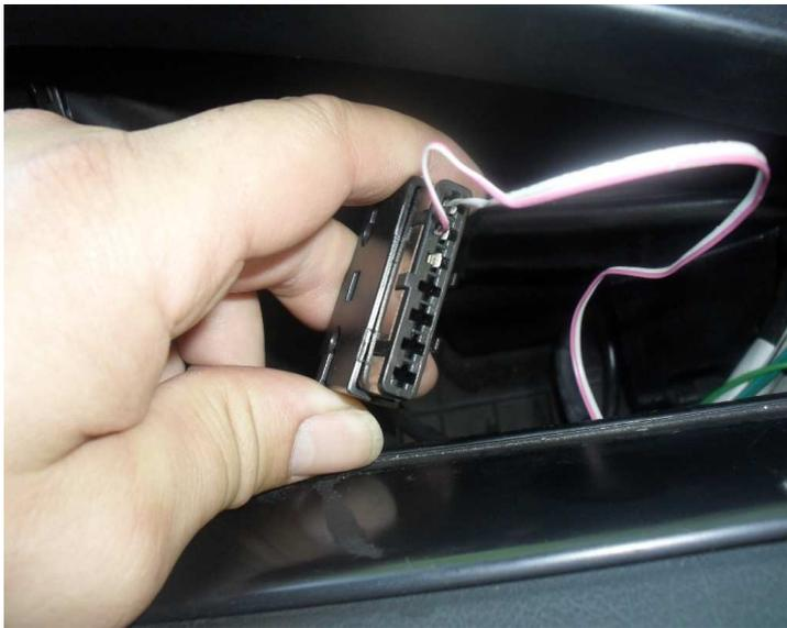
Una vez tengamos los cables montados los pasamos entre el salpicadero y la radio, soldamos el led con su respectiva polaridad y lo ubicamos, probamos que todo funcione, montamos el airbag y listo.
