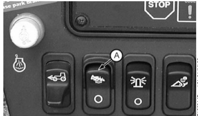
A—Interruptor de control de suspensión
