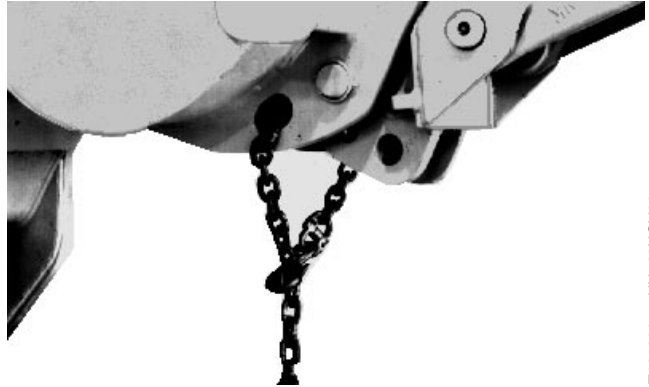
Elevación con la retroexcavadora
